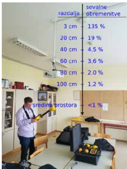
Slika 6: Vrednosti električnega polja v odstotkih mejne vrednosti (UI RS 70/96) glede na razdaljo od naprave Wi-Fi, ki je nameščena na stropu učilnice Osnovne šole Lenart.
