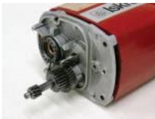
Zobniki pri vrtnem stroju To obliko zobnikov imenujemo valjasti zobniki.
